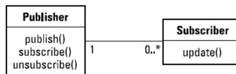
Mantiene sincronizado el estado de los componentes:
